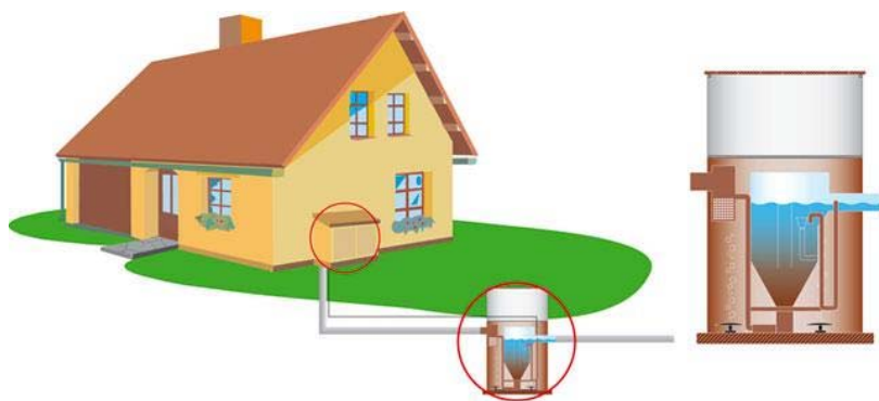
Tampon de \varnothing 60 cm verrouillable donnant accès au coffret abritant le surpresseur d'air et le programmeur
